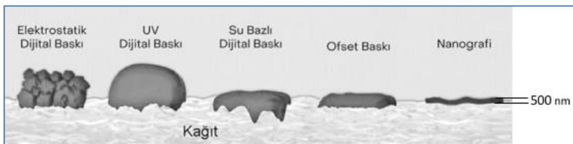
Şekil 1: Basılı yüzeylerdeki farklı baskılardaki mürekkep yüzey kalınlıkları
